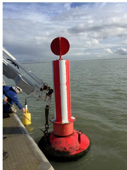
Mise en place d'une sonde multiparamètres / IFREMER
