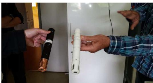
Sonde STPS de mesure de salinité, température, pressions / RNN BA
