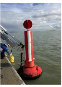
Mise en place d'une sonde multiparamètres / IFREMER
