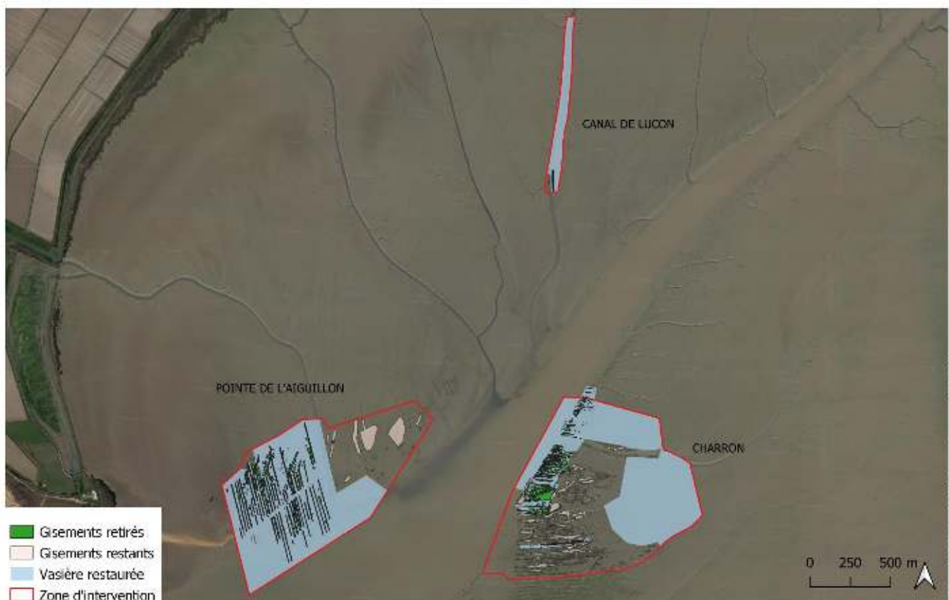
Cartographie 5 : Surface de vasière restaurée sur les 3 zones d'intervention en fonction de la phase de travaux.
