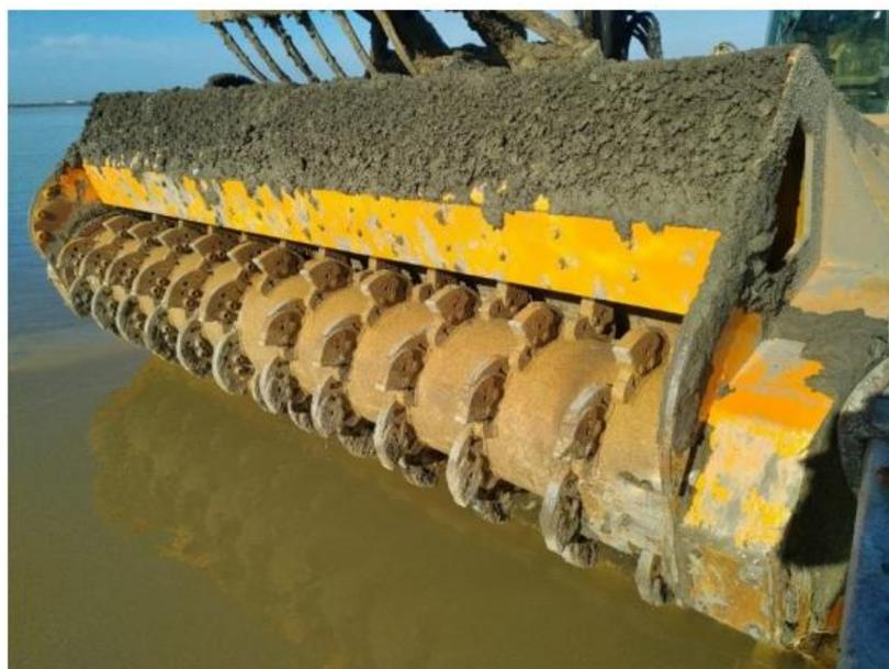
Nature 2050 : Baie de l'Aiguillon - Broyeur frontal de la nouvelle machine conçue par SAS CTAT © Réserve Naturelle Nationale de la Baie de l'Aiguillon
