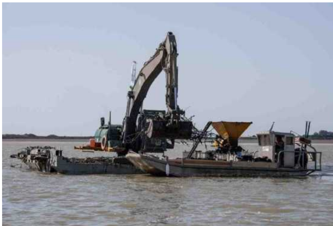
La pelle mécanique nettoie les vasières depuis une plateforme flottante. PHOTO XAVIER LÉOTY
